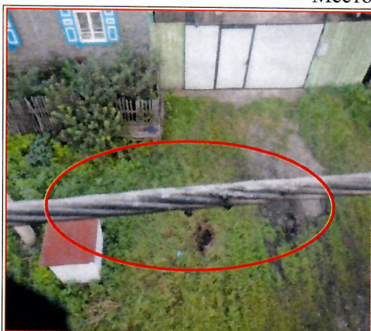
Место НС (следы КЗ на проводе ВЛ и на месте установки крана – манипулятора)
